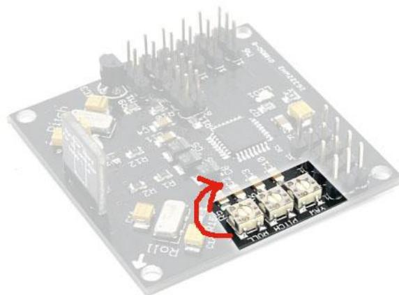
Les valeurs des potentiomètres de gain sont de 50%. Augmenter leur valeur jusqu'à ce que le quadri commence à osciller rapidement, puis diminuer jusqu'à ce qu'il soit de nouveau stable. Pour les vols rapides vers l'avant, les gains des Pot doivent être faibles. (Jamais en dessous de 30%).
