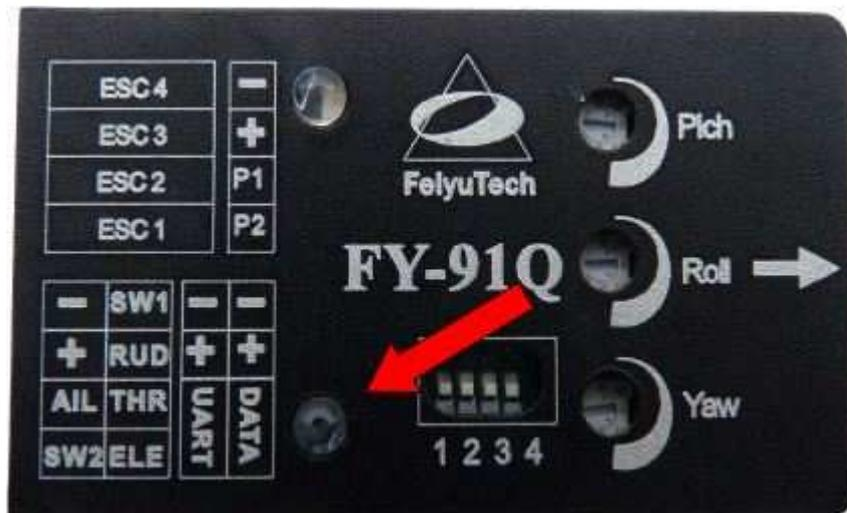
Le statut de connexion GPS et le niveau de vibrations sont indiqués par la LED Rouge :
